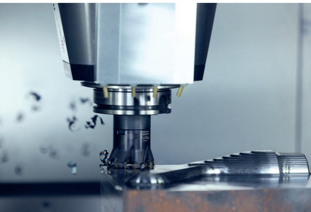
1 Der Xtra-tec-XT-Rundplattenfräser M5468, hier in einem Vorbearbeitungsprozess, wurde entwickelt mit der Zielgröße maximale Produktivität bei größtmöglicher Prozesssicherheit, Bauteilqualität und Schneidenstandzeit © Walter AG
